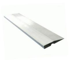
проведении чистовых отделочных работ добивается максимальной ровности и гладкости стеновых поверхностей. Штукатурное правило широко применяется для этих целей при различных строительных и штукатурных работах. Изделия выполняются в трапециевидной форме из высокопрочного алюминиевого сплава. В работе с данным инструментом важную роль играет дополнительное ребро жесткости
